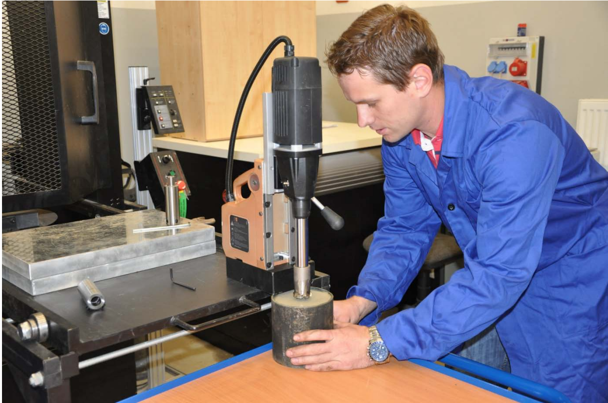
Obr. 1 – Zkoušky funkčního vzorku v laboratoři při odvrtávání vzorku z bentonitu
