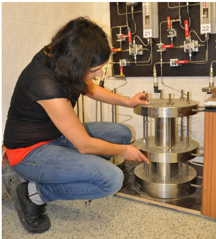
Obr. 1 – Komora napojená na zařízení propustoměřů
