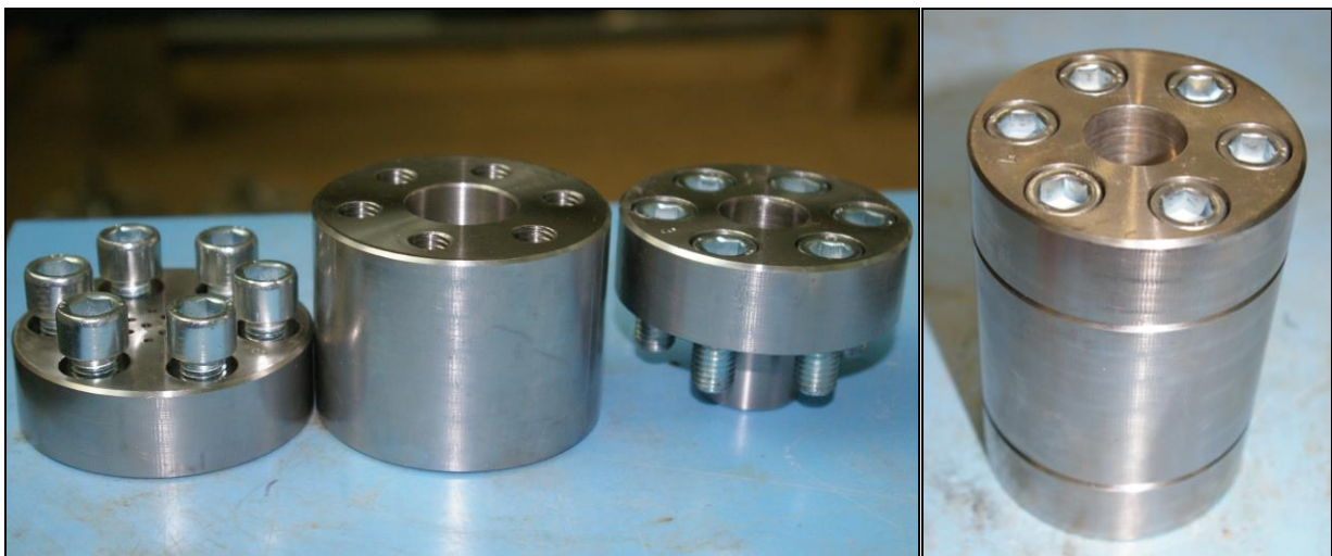
Obr. 1 – Přípravek pro sycení bobtnavých materiálů – rozložený (vlevo) a složený (vpravo)
